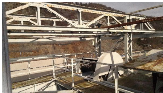
Lanový naviják hlavního zdvihacího zařízení
