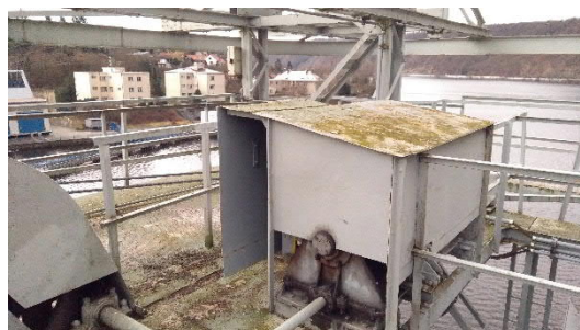
Pohon pojezdu jeřábu umístěný na ovládací plošině
